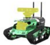
JetTank Standard Kit con Scanner LIDAR e Videocamera
